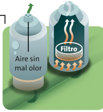
**CILINDROS DE BIOFILTROS** Recogen el gas de las aguas servidas. Los cilindros contienen bacterias y químicos que eliminan el sulfuro de hidrógeno, causante del mal olor característico de materia en descomposición.
