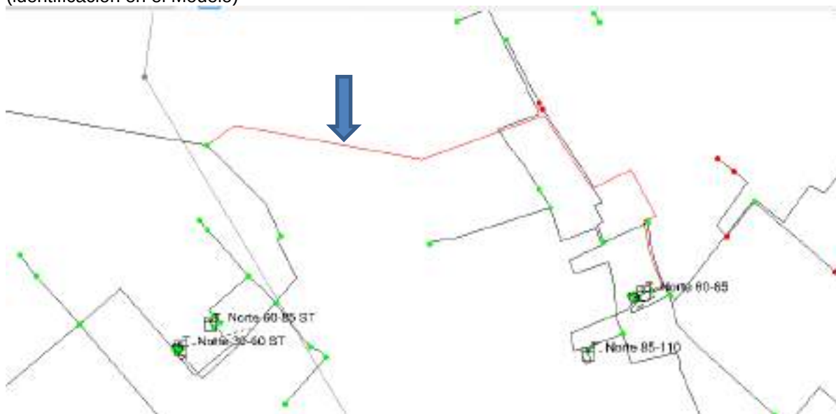
Figura 13.74: Desconexión tubería de alimentación a tanques 60-85 y 30-60 Zona Sergio Toral (identificación en el Modelo)
