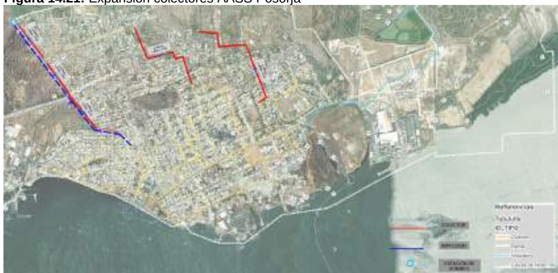
Figura 14.21: Expansión colectores AASS Posorja
