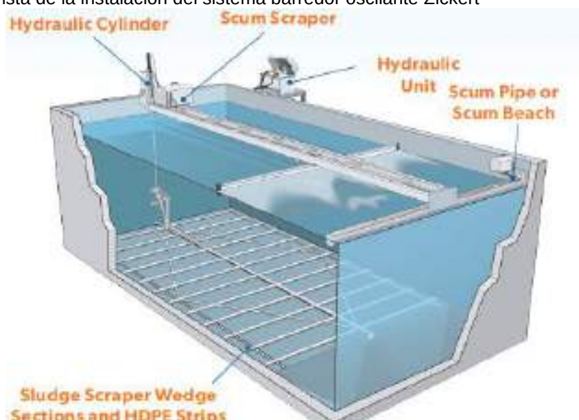
Figura 13.1: Vista de la instalación del sistema barredor oscilante Zickert
