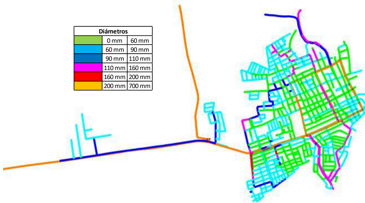
Figura 13.29: Modelo Escenario al 2031 Red de Distribución de AAPP – Diámetros (Posorja)
