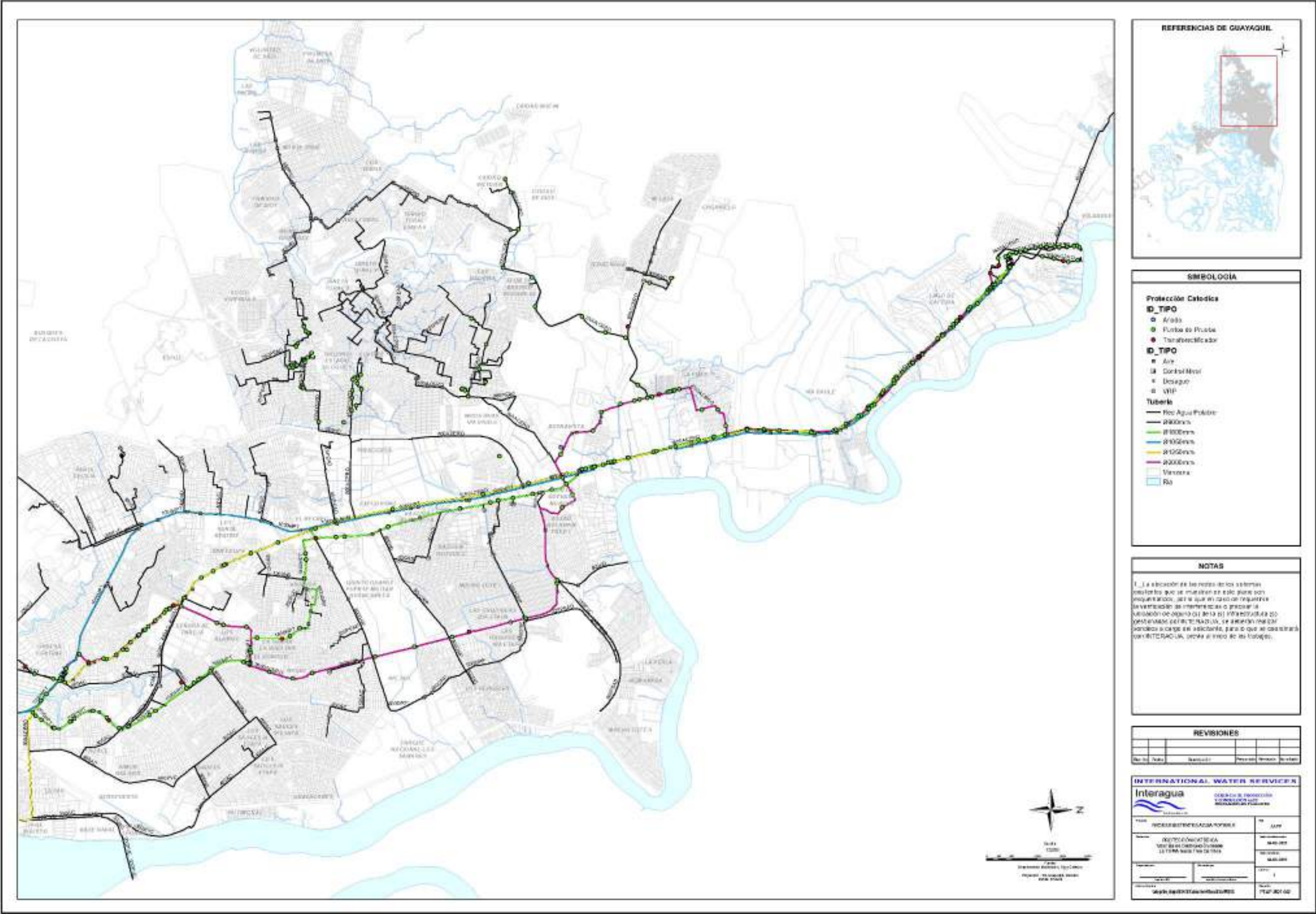
Figura 13.120: Protección catódica – Tuberías de distribución desde La Toma hasta Tres Cerritos
