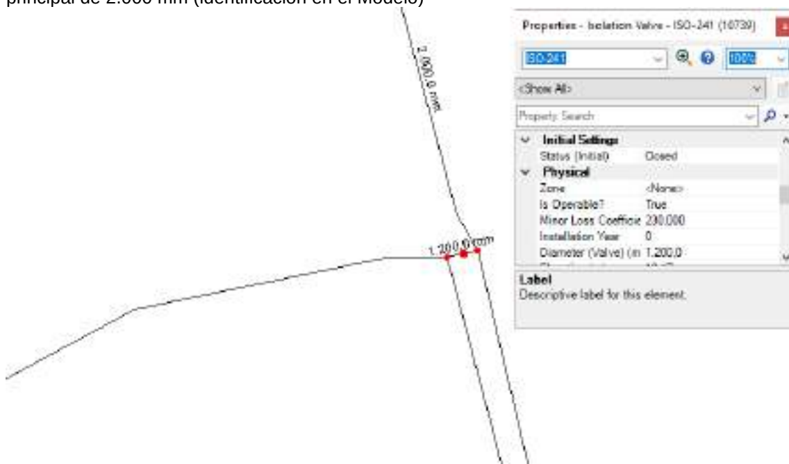
Figura 13.74: Desconexión tubería de alimentación a tanques 60-85 y 30-60 Zona Sergio Toral (identificación en el Modelo)
